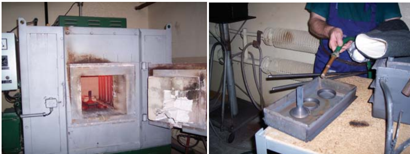
Rys. 2. Metodyka badań: wygrzanie w piecu w temperaturze 900^{\circ}\text{C} przez 15 minut i szybkie studzenie sprężonym powietrzem do temperatury otoczenia
