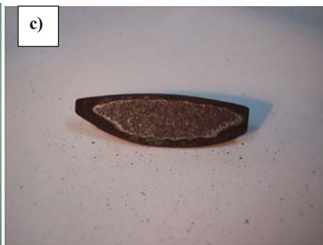
Rys. 7. Próbkę wyciętą z zaworu wydechowego do badań żaroodporności w temperaturze 900°C: a) stan odprysków warstwy tlenków po 2 minutach od wyjęcia z pieca, b) po 5 minutach
