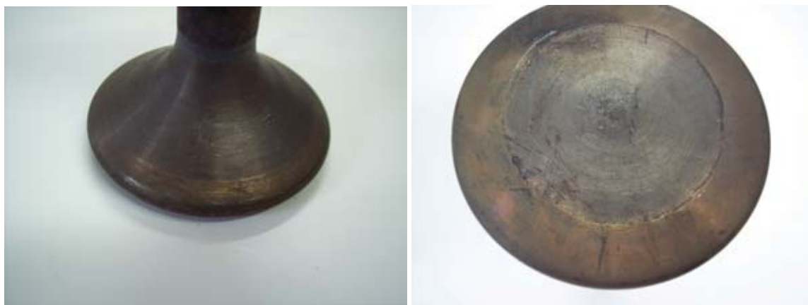
Rys.3. Wygląd powierzchni grzybka zaworu po 20 cyklach nagrzewania i chłodzenia
