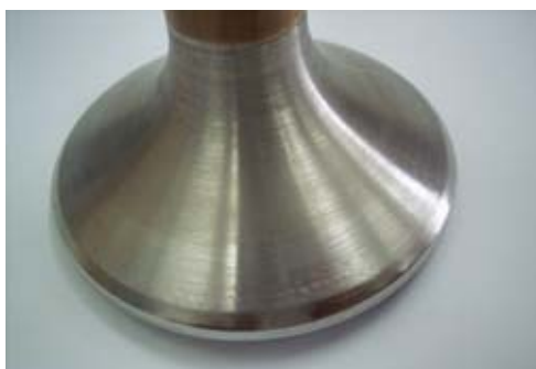
Rys. 1. Ogólny widok zaworów poddanych badaniom w warunkach szoku termicznego i środowiska korozyjnego – widok przed badaniami
